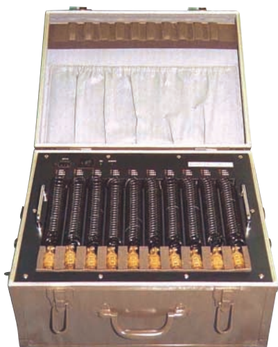
PDPエージング装置電源 (15KW)
